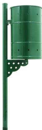
Cestino diam. 300 mm - H. 480 mm. Palo di sostegno H. 1200 mm. Realizzato in lamiera zincata e verniciato a polveri epossidiche. Il cestino è ancorato al palo da un perno che consente lo sfilaggio e la rotazione.
