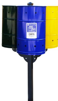
Cestini diam. 300 mm - H. 480 mm. Palo di sostegno H. 1200 mm. Realizzato in lamiera zincata e verniciato a polveri epossidiche. Il cestino è ancorato al palo da un perno che consente lo sfilaggio e la rotazione
